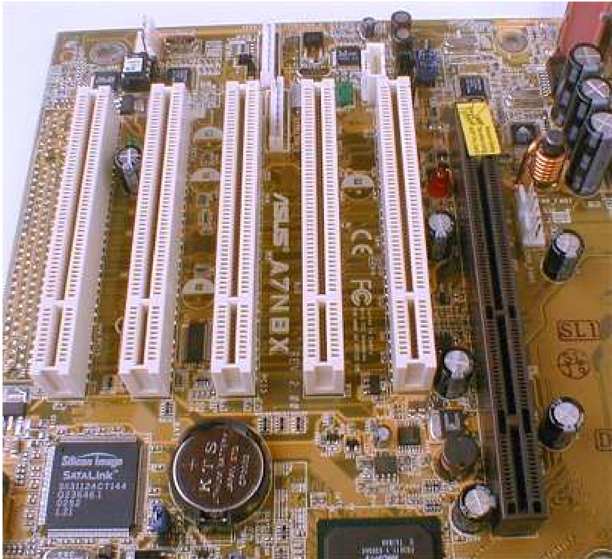
Abbildung: Fünf PCI-Slots auf dem ASUS-Motherboard A7N8X Deluxe, rechts daneben der dunkler eingefärbte AGP2.0/3.0-Steckplatz (Quelle: www.planet3dnow.de )
